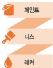
도장공사는 방부(防腐)·방청(防錆)·방충(防蟲)·방화나 장식을 목적으로 목적물의 표면에 도막을 형성시켜 목적물이 내습성(耐濕性)·내후성(耐朽性)·내약품성을 갖도록 하기 위해 한다. 건축공사에서는 광선의 조절과 방음, 방사선 방어를 위해 도장하는 경우도 있다. 도장재료에는 페인트·니스·래커 등이 있으며, 도장공정은 일반적으로 바탕처리→하도(초벌)→중도(제벌)→상도(정벌)의 과정을 거치며, 도료의 종류 및 목적에 따라 공정의 일부가 생략, 추가 또는 병합되기도 한다.
